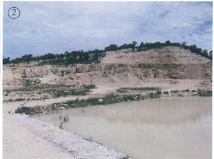
การทำเหมืองแบบขั้นบันได ความสูง Bench 5 เมตร และมีความลาดเอียงไม่เกิน 45 องศา
